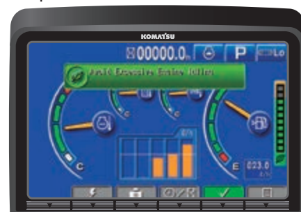
Instelbare eco-meter en waarschuwing stationair draaien
