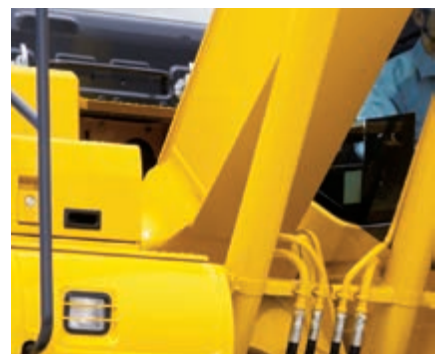
Gegoten giekvoet en giekplaten uit één stuk
